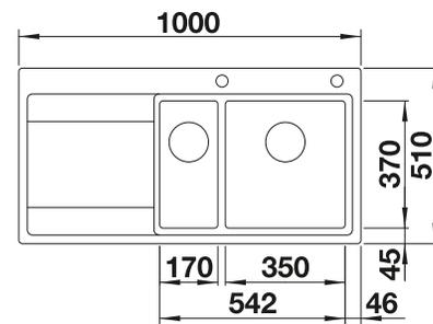
Profondeur de la cuve : 195/135 mm
