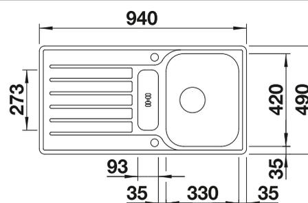
Profondeur de la cuve : 165/40 mm
