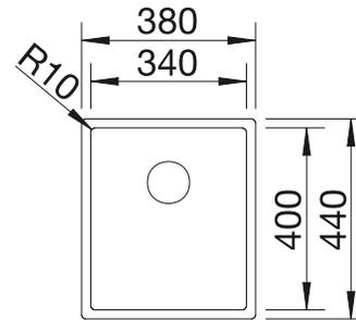
Profondeur de la cuve : 190 mm
