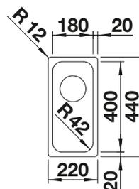
Profondeur de la cuve : 125 mm
