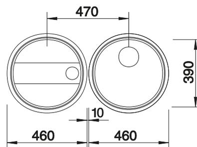
Profondeur de la cuve : 175/35 mm
