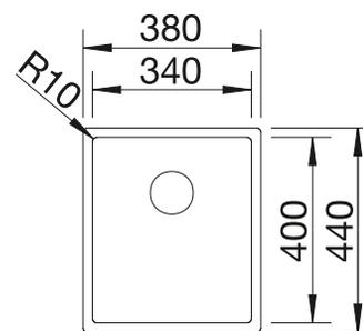
Profondeur de la cuve : 190 mm
