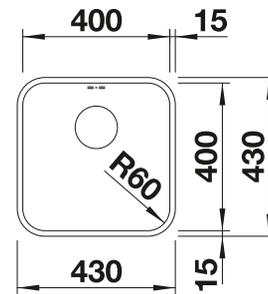
Profondeur de la cuve : 175 mm
