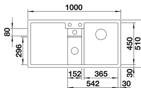
Profondeur de la cuve : 190/155/45 mm
