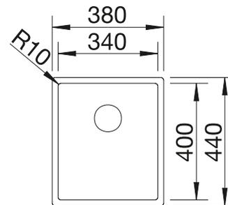
Profondeur de la cuve : 190 mm
