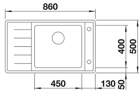
Profondeur de la cuve : 215 mm
