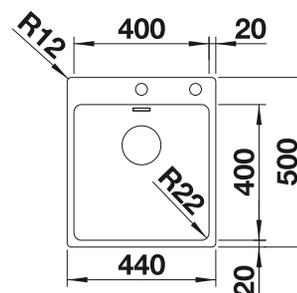
Profondeur de la cuve : 190 mm
