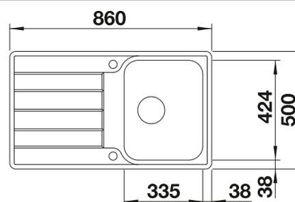
Profondeur de la cuve : 205 mm
