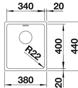
Profondeur de la cuve : 190 mm
