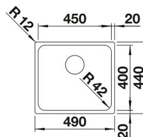
Profondeur de la cuve : 185 mm
