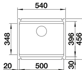
Profondeur de la cuve : 200 mm
