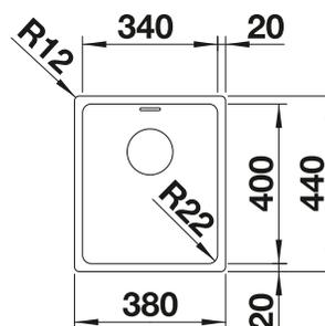
Profondeur de la cuve : 190 mm
