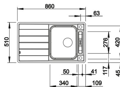
Profondeur de la cuve : 190/40 mm
