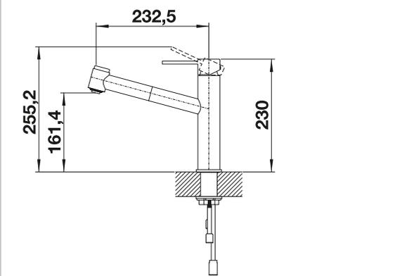
Débit 8.3 (Haute pression) / 7 (basse pression) l/min à 3 bar de pression
