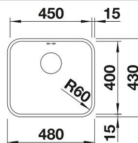
Profondeur de la cuve : 175 mm
