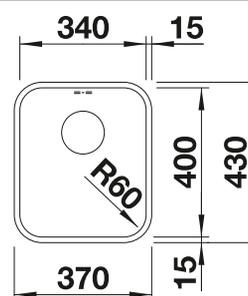
Profondeur de la cuve : 175 mm
