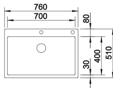
Profondeur de la cuve : 190 mm
