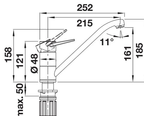
Débit 14.98 (Haute pression) / 5.28 (basse pression) l/min à 3 bar de pression
