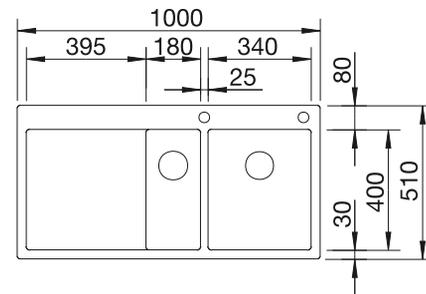
Profondeur de la cuve : 190/130 mm
