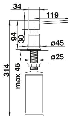
Percement de Ø 35 mm nécessaire
