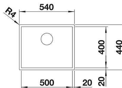
Profondeur de la cuve : 175 mm
