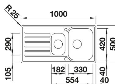
Profondeur de la cuve : 170/90 mm
