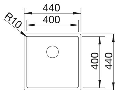
Profondeur de la cuve : 190 mm
