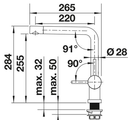
Débit 14 (Haute pression) / 5 (basse pression) l/min à 3 bar de pression
