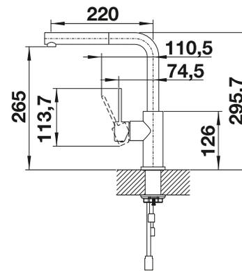
Débit 8,6 (Haute pression) / 7 (basse pression) l/min à 3 bar de pression
