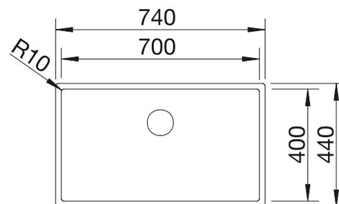
Profondeur de la cuve : 190 mm
