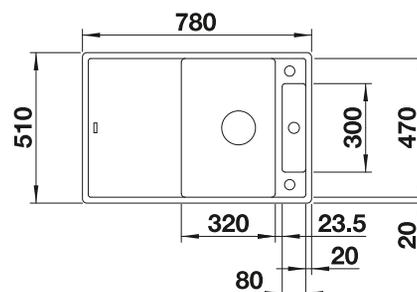
Profondeur de la cuve : 190/20 mm
