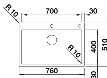
Profondeur de la cuve : 190 mm
