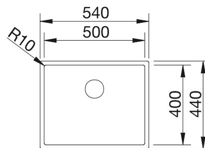
Profondeur de la cuve : 190 mm
