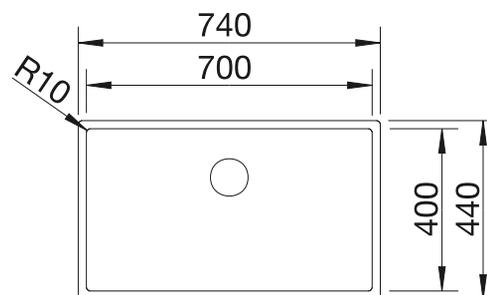
Profondeur de la cuve : 190 mm
