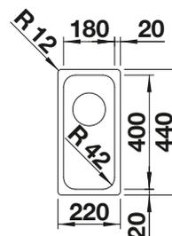
Profondeur de la cuve : 125 mm
