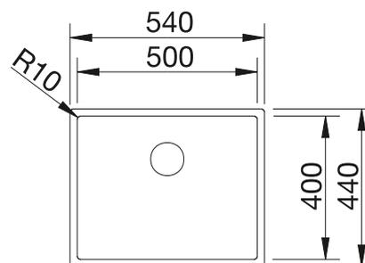
Profondeur de la cuve : 190 mm
