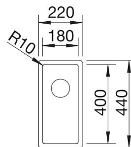
Profondeur de la cuve : 130 mm
