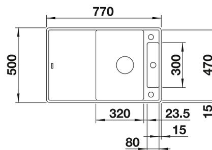
Profondeur de la cuve : 190/20 mm
