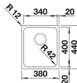
Profondeur de la cuve : 185 mm
