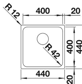
Profondeur de la cuve : 185 mm
