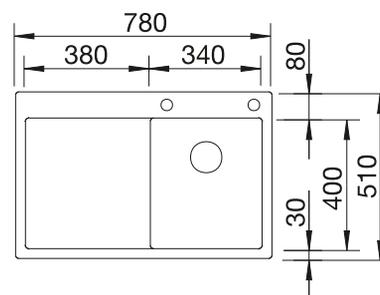
Profondeur de la cuve : 190 mm
