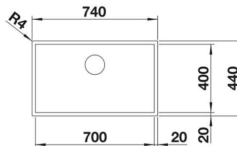
Profondeur de la cuve : 185 mm
