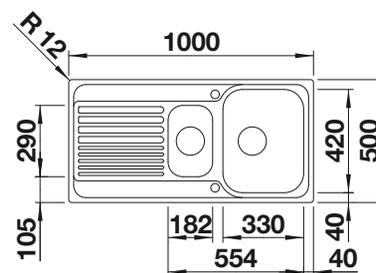
Profondeur de la cuve : 170/90 mm
