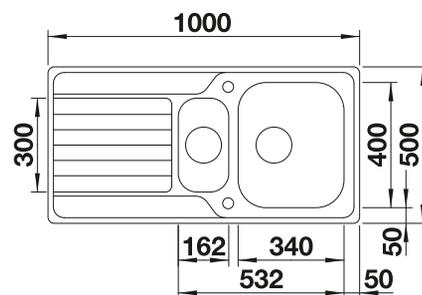
Profondeur de la cuve : 195/145 mm
