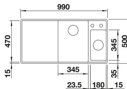
Profondeur de la cuve : 190/145 mm
