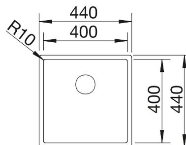
Profondeur de la cuve : 190 mm
