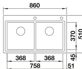
Profondeur de la cuve : 196/196 mm
