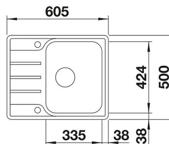
Profondeur de la cuve : 205 mm
