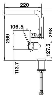
Débit 10.5 (Haute pression) / 5.2 (basse pression) l/min à 3 bar de pression
