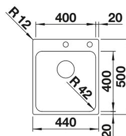
Profondeur de la cuve : 185 mm
