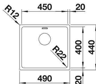
Profondeur de la cuve : 190 mm
