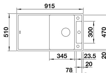
Profondeur de la cuve : 190/55 mm
