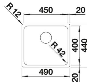
Profondeur de la cuve : 185 mm
