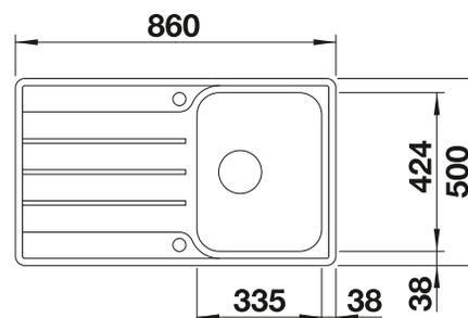
Profondeur de la cuve : 205 mm
