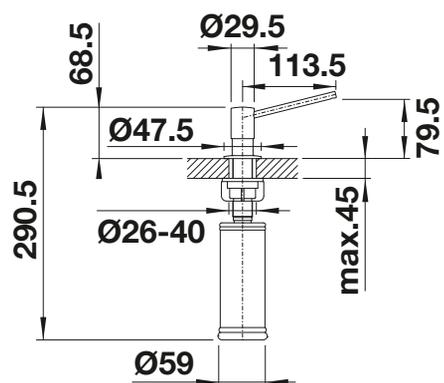
Perçage de Ø 35 mm nécessaire
