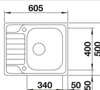
Profondeur de la cuve : 195 mm
