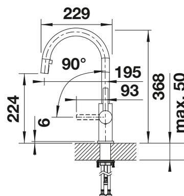
Débit 9.7 (Haute pression) / 5 (basse pression) l/min à 3 bar de pression
