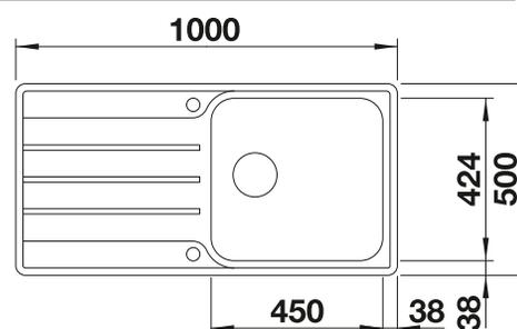
Profondeur de la cuve : 205 mm
