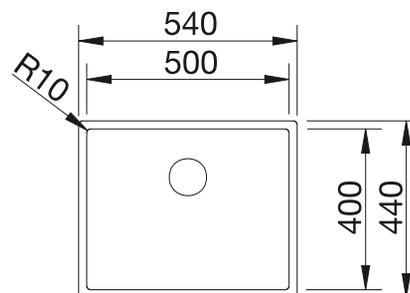
Profondeur de la cuve : 190 mm
