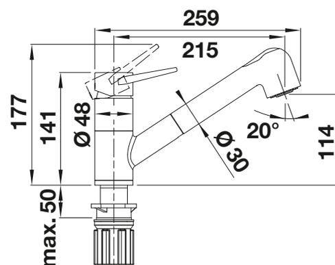
Débit 9.23 (Haute pression) / 4.89 (basse pression) l/min à 3 bar de pression
