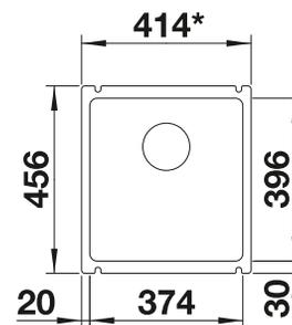
Profondeur de la cuve : 185 mm
