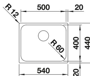
Profondeur de la cuve : 175 mm
