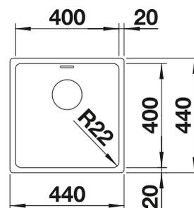
Profondeur de la cuve : 190 mm
