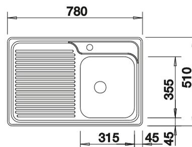
Profondeur de la cuve : 195 mm
