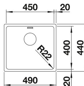
Profondeur de la cuve : 190 mm
