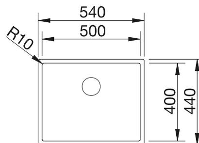
Profondeur de la cuve : 190 mm
