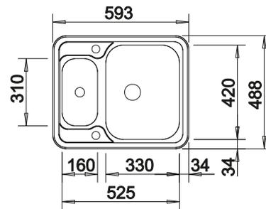
Profondeur de la cuve : 160/130 mm
