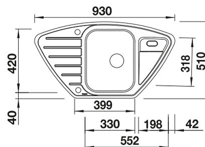
Profondeur de la cuve : 170/35 mm
