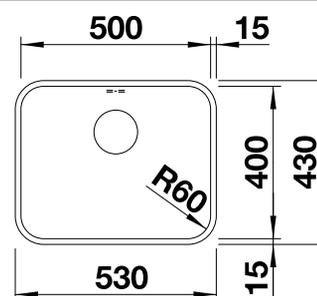
Profondeur de la cuve : 175 mm
