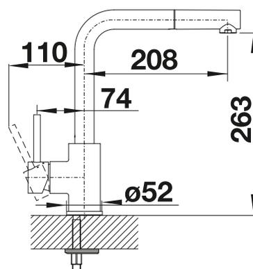
Débit 10.2 (Haute pression) / 7 (basse pression) l/min à 3 bar de pression
