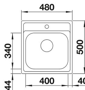
Profondeur de la cuve : 158 mm
