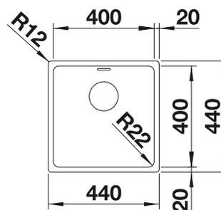
Profondeur de la cuve : 190 mm
