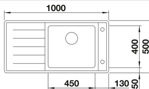
Profondeur de la cuve : 215 mm
