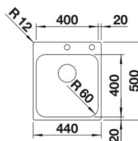
Profondeur de la cuve : 175 mm
