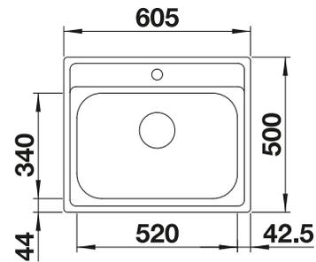
Profondeur de la cuve : 158 mm
