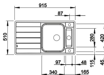
Profondeur de la cuve : 190/60 mm
