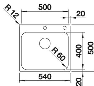
Profondeur de la cuve : 175 mm
