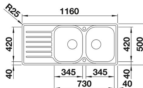
Profondeur de la cuve : 165/165 mm
