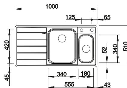
Profondeur de la cuve : 190/130 mm
