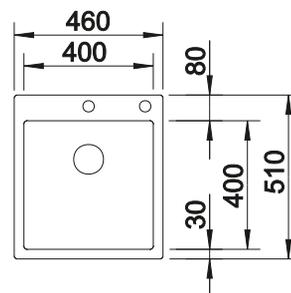
Profondeur de la cuve : 190 mm
