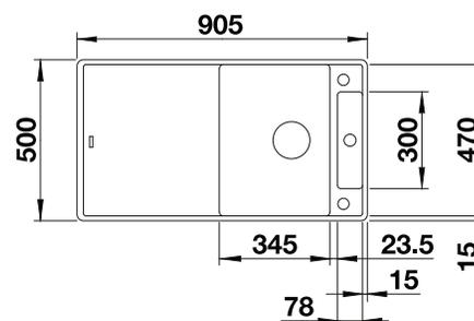
Profondeur de la cuve : 190/55 mm
