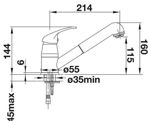
Débit 10.6 (Haute pression) / 9.1 (Haute pression) / 6.2 (basse pression) / l/min à 3 bar de pression
