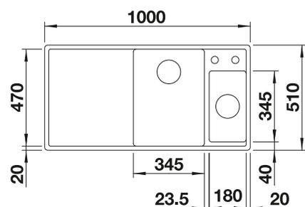
Profondeur de la cuve : 190/145 mm
