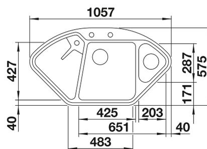
Profondeur de la cuve : 185/130 mm
