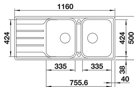
Profondeur de la cuve : 205/205 mm
