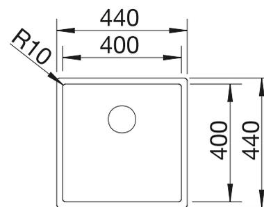
Profondeur de la cuve : 190 mm
