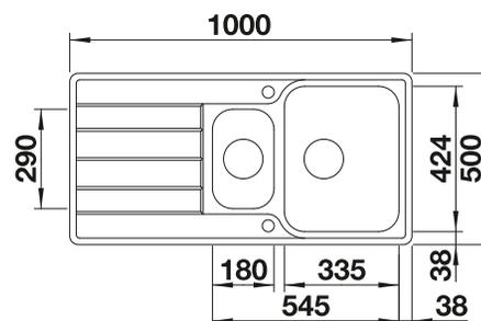
Profondeur de la cuve : 205/145 mm
