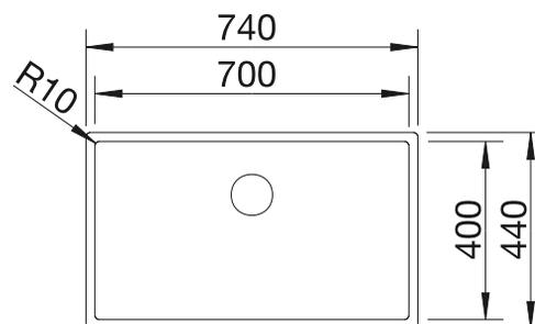
Profondeur de la cuve : 190 mm
