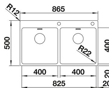
Profondeur de la cuve : 190/190 mm
