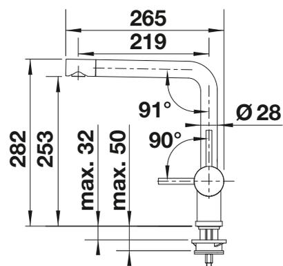
Débit 14.4 (Haute pression) / 7 (basse pression) l/min à 3 bar de pression
