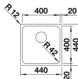
Profondeur de la cuve : 185 mm
