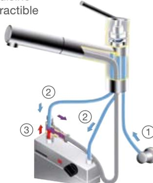
① Raccordement d'eau froide
