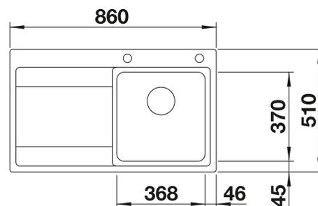
Profondeur de la cuve : 195 mm
