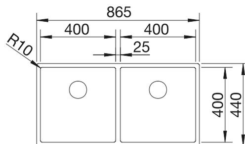
Profondeur de la cuve : 190/190 mm
