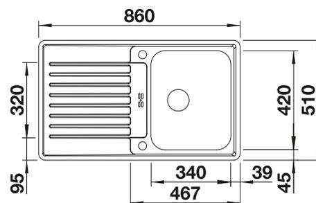
Profondeur de la cuve : 185 mm
