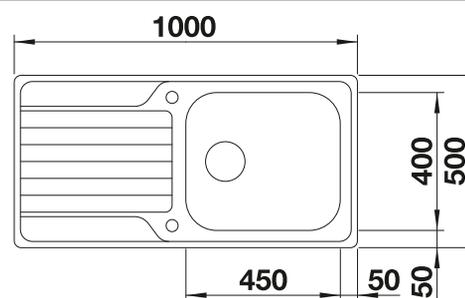
Profondeur de la cuve : 195 mm
