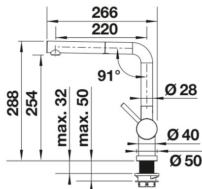
Débit 9.6 (Haute pression) / 5 (basse pression) l/min à 3 bar de pression
