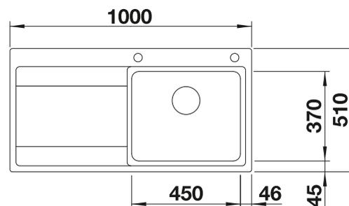
Profondeur de la cuve : 195 mm
