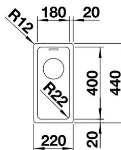
Profondeur de la cuve : 130 mm
