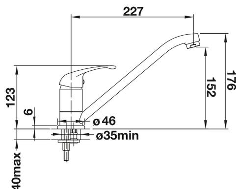
Débit 15.4 (Haute pression) / 6.2 (basse pression) l/min à 3 bar de pression
