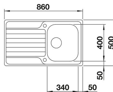
Profondeur de la cuve : 195 mm
