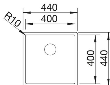
Profondeur de la cuve : 190 mm
