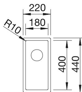
Profondeur de la cuve : 130 mm
