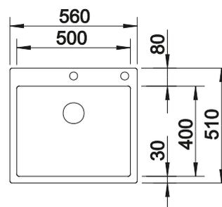
Profondeur de la cuve : 190 mm
