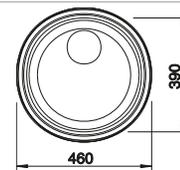
Installation sous plan sans porte-à-faux, découpe requise Ø 424 mm.
