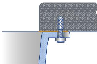
Pour le montage sous-plan d'éviers encastrables, il convient de faire appel à des éléments de fixation spéciaux.
