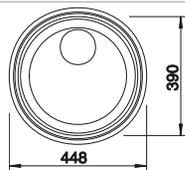
Découpe pour IF – rebord plat pour installation à poser sur le plan de travail à partir du dessus
