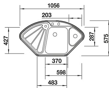
Profondeur de la cuve : 185/130 mm
