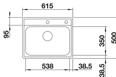
Profondeur de la cuve : 205 mm
