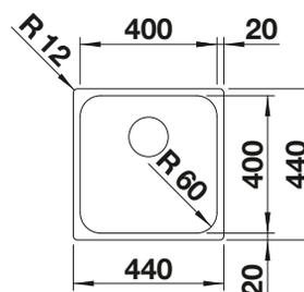
Profondeur de la cuve : 175 mm
