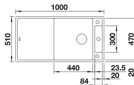
Profondeur de la cuve : 190/45 mm
