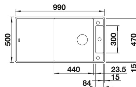
Profondeur de la cuve : 190/45 mm
