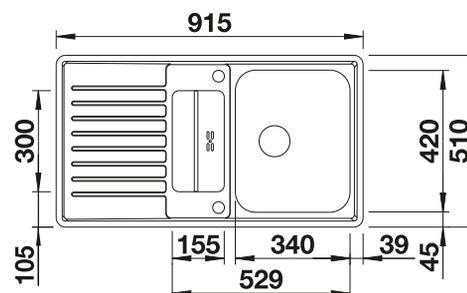
Profondeur de la cuve : 185/55 mm
