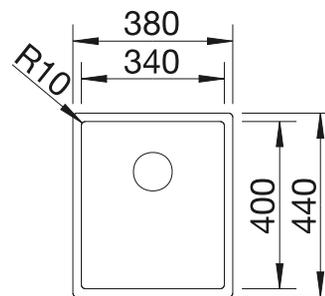
Profondeur de la cuve : 190 mm
