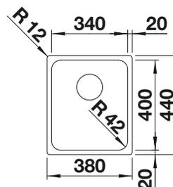
Profondeur de la cuve : 185 mm
