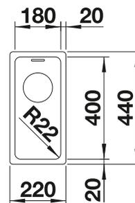
Profondeur de la cuve : 130 mm
