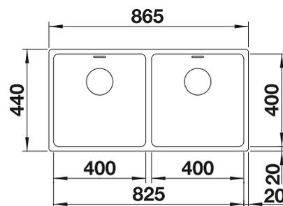
Profondeur de la cuve : 190/190 mm
