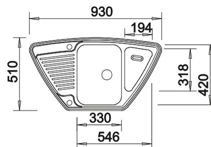
Profondeur de la cuve : 165/30 mm
