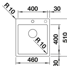
Profondeur de la cuve : 190 mm
