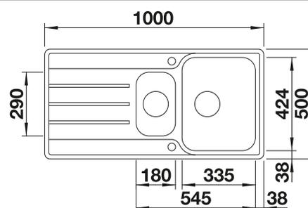
Profondeur de la cuve : 205/145 mm
