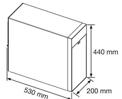
Das System benötigt trotzdem ein Mindestvolumen des Unterschranks für die warme Abluft oder alternativ ausreichend dimensionierte Lüftungsöffnungen, um einen dauerhaften Luftaustausch aus dem Unterschrank heraus zu gewährleisten.
